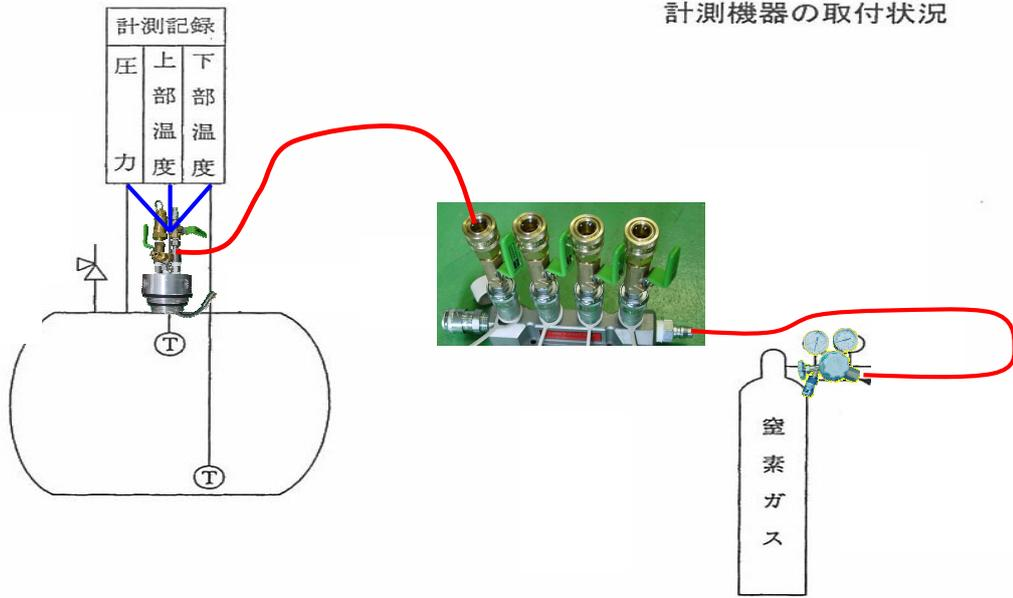
図5-2 単槽タンクの機器取付の例
