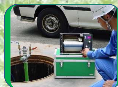
気相部漏洩検査用圧力レコーダー
