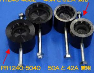
PR1241 通気管簡易密閉試験治具
