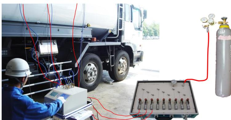
エアー分配器は、槽の容量の2kl/4klにスイッチを切替えると、容量が違ってもほぼ同じ時間に20kPaに到達します。
