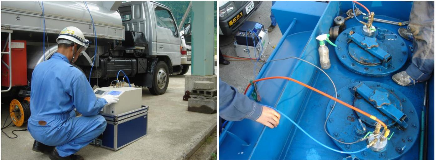
ガス加圧試験の機器取付例
